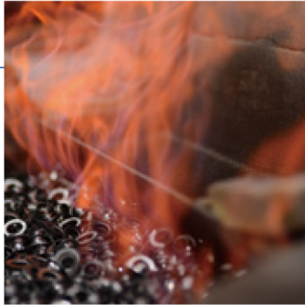
鋼を加熱と冷却を加えることで硬さが得られ、耐摩耗性や耐疲労性が向上する
